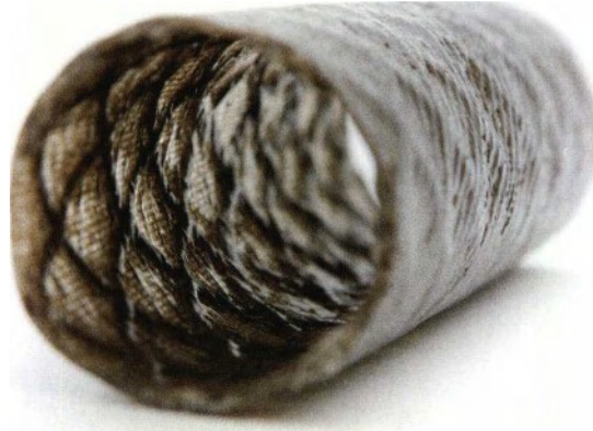
Ein Rohr aus Flachsfasern, das beispielsweise für Velorahmen verwendet wird.
